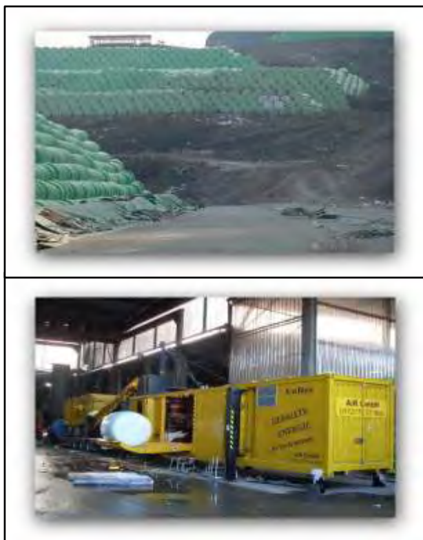
Рис. 4.5.2. Упаковочная техника и материалы для прессования и упаковки остаточных отходов
